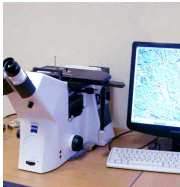
PMI-MASTER Sort, исследовательский световой микроскоп высшего класса Observer A-Im. Все измерительное оборудование проходит ежегодную метрологическую поверку ФГУ «Томский ЦСМ».
