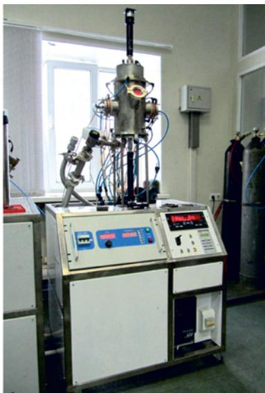
Установка для газофазного осаждения
