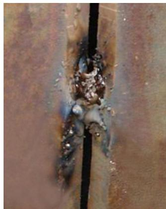
*Результат попытки сварки намагниченной трубы с применением стандартных сварочных источников питания (сварка невозможна)*
