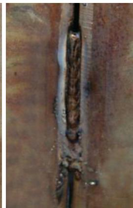
*Результат попытки сварки намагниченной трубы с применением ИСТ-201 (разработка ТПУ)*
