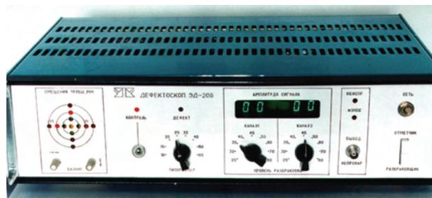
Электронный блок дефектоскопа ЭД-208
