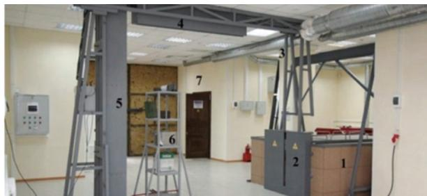
**Инспекционно-досмотровый комплекс с бетатроном МИБ-9:** 1 – бокс с бетатроном, 2 – коллиматор, 3 – детекторный портал, 4 – горизонтальная линейка детекторов, 5 – вертикальная линейка детекторов, 6 – полка с тестирующим материалом, 7 – операторская.
