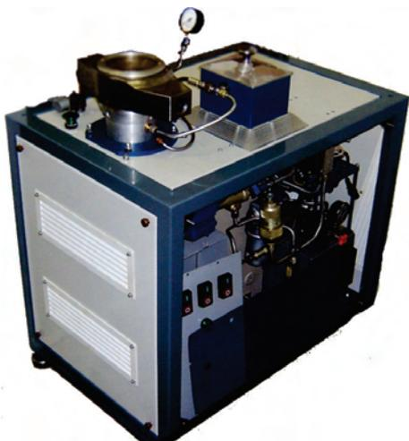
нейный износ пары трения (от 0 до 2 мм); избыточное давление смазочной среды в камере трения (от 0 до 1 МПа).
