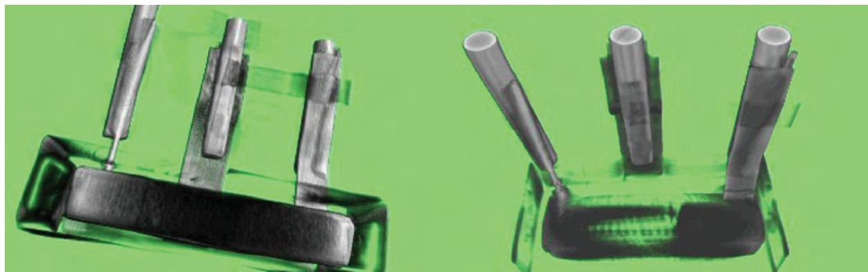
Просвеченный на TOLMI 150-10 катод ускорителя
