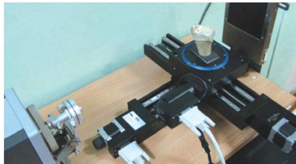
Компактный микротомограф TOLMI-150-10
