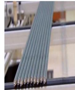
Твэл - тепловыделяющий элемент (металлическая трубка с керамическим ядерным топливом)
